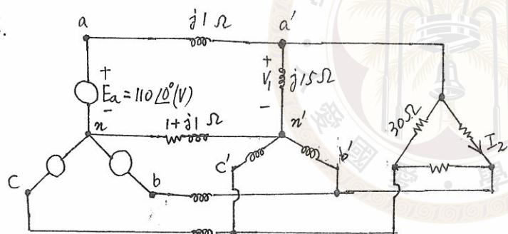
左圖所示為一平衡三相電力系統。
