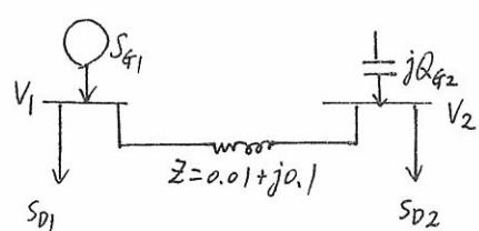
左圖為一電力系統之單綿圖。若  $V_1 = 1 \angle 0^\circ$ ，
